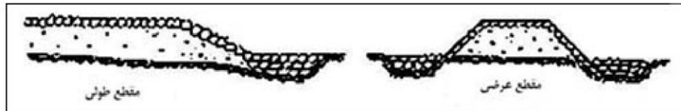
شکل ۶-۱۳- مقطع طولی و عرضی آبشکن با مصالح رودخانه‌ای و روکش سنگ‌ریزه‌ای [۱۰۴]
